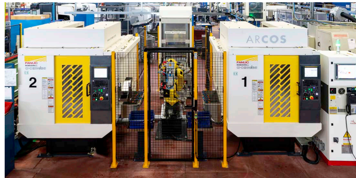
Sistema Arcos per l'asservimento a due centri di lavoro FANUC
