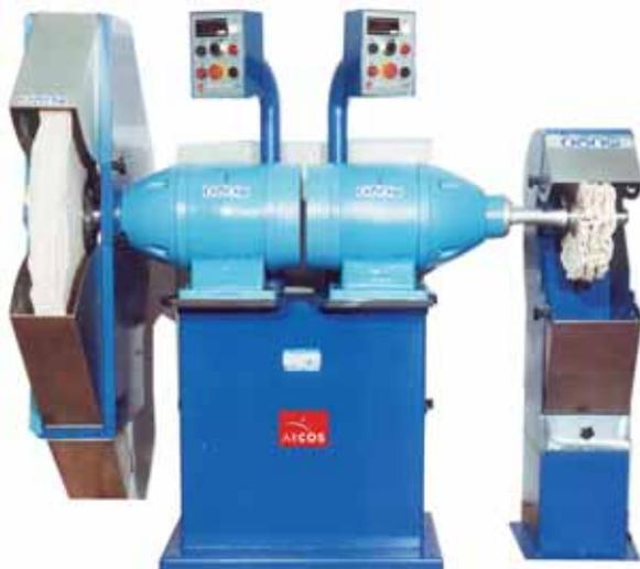
2TS/A Pulitrice a Due Teste con Variatore di Velocità
