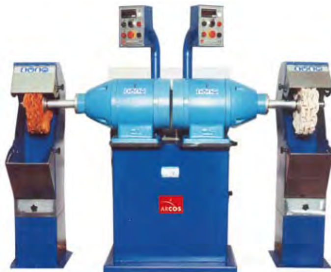
2TS/F Двухголовочный зачистной станок с вариатором скорости
