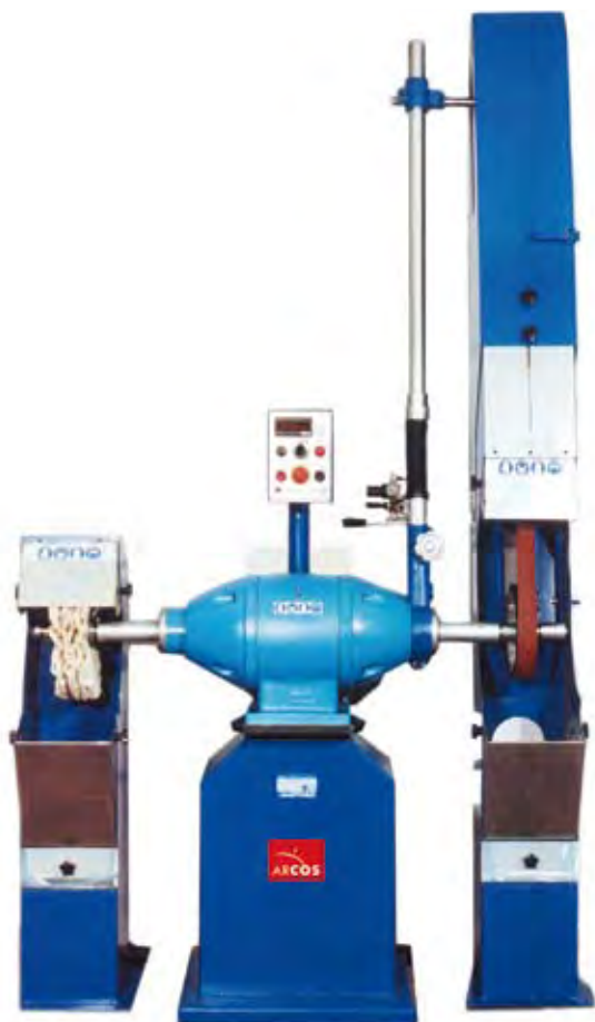
Q/D Зачистной/шлифовальный станок с вариатором скорости
